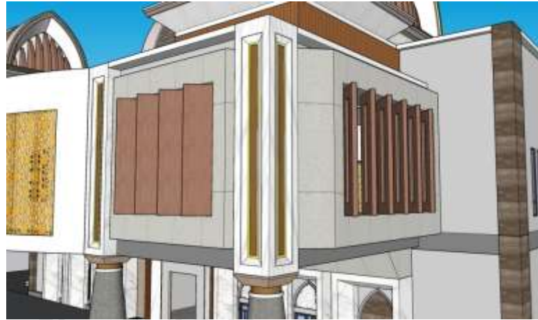
Gambar 4. 5 Bentuk Struktur Pemecah Angin/Secondary Skin
