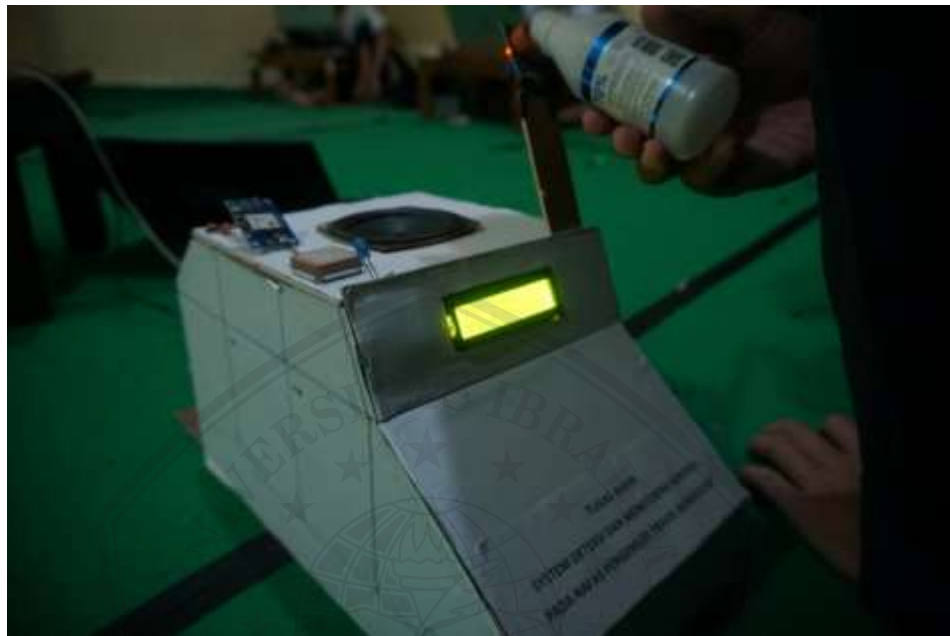
Gambar 4.2 Rangkaian Pengujian Sensor Alkohol
