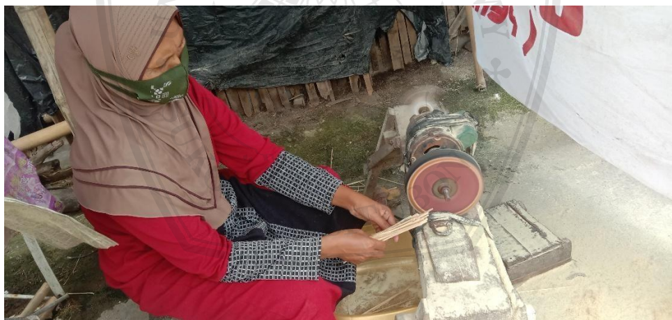
Gambar. Proses Penajaman Menggunakan Mesin
