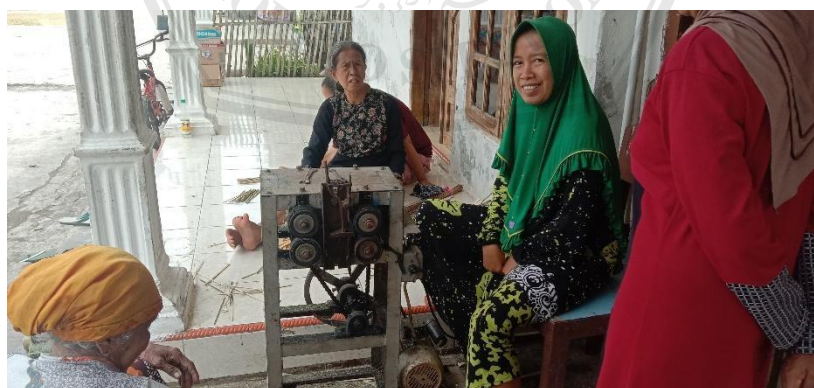
Gambar. Proses Pembelahan Bambu Menjadi Tusuk Sate Menggunakan Mesin
