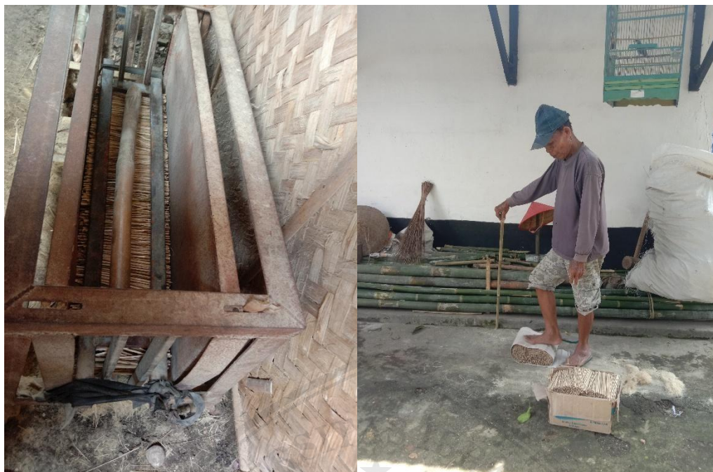
Gambar. Penghalusan Tusuk Sate Dengan Cara Manual Dan Mesin
