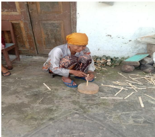
Gambar. Proses Pembelahan Tusuk Sate Menggunakan Manual
